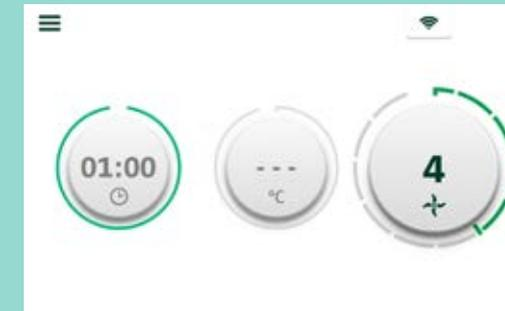
**Achtung: Die Zeit immer auf maximal 1 Minute einstellen, um ein Überfüllen des Auffangeinsatzes zu vermeiden, und immer die Stufe 4 nutzen.**
