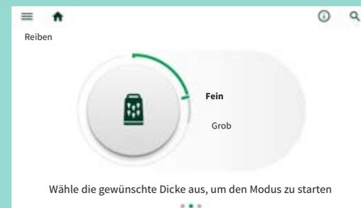
In jedem Modus kannst du wählen, ob du einen feinen oder einen dicken Schnitt möchtest. Drehe einfach den Wähler, um eine der Optionen auszuwählen, und der Modus wird gestartet. Lege die Zutat in die Einfüllöffnung und drücke sie mit dem Schieber vorsichtig nach unten. Den Wähler berühren, um den Modus zu stoppen, wenn du mit dem Schneiden oder Reiben fertig bist. Sollte der Modus automatisch nach 1 Minute stoppen, überprüfe den Auffangeinsatz und leere ihn gegebenenfalls, bevor du weitermachst.
